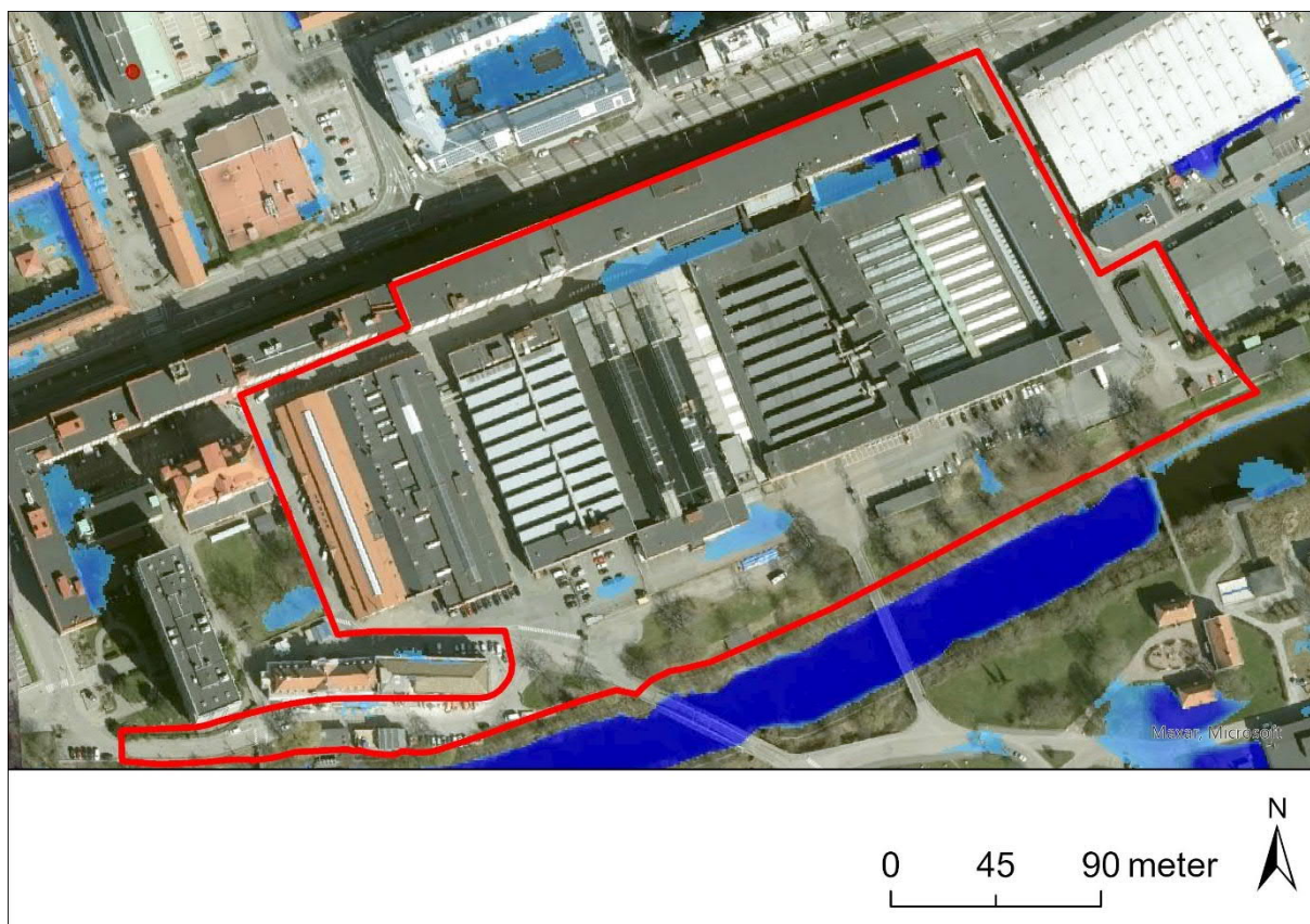
Figur 14. Blå områden visar vattendjup vid skyfall i området, där mörkare blå indikerar djupare lågpunkter och ljusare blå grunda lågpunkter. Planområdets avgränsning markeras med rött.
